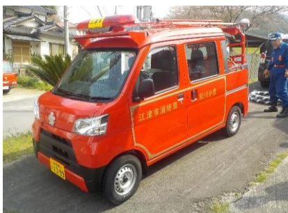
小型動力ポンプ積載車
