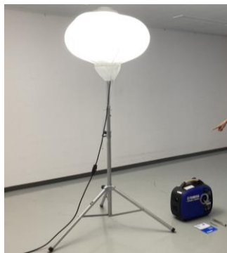
投光器、発電機セット
