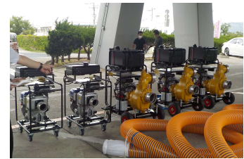
緊急排水エンジンポンプ
