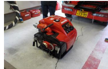
小型動力ポンプ
