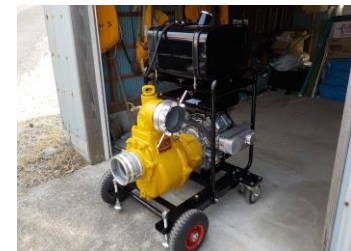
緊急排水エンジンポンプ
