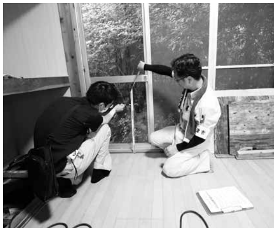
被災した家屋の被害認定調査。浸水した深さなどを調査しました。
