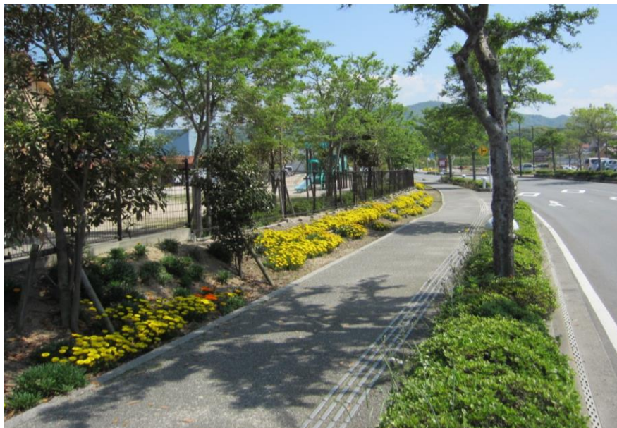
点字ブロック設置（シビックセンターゾーン）
