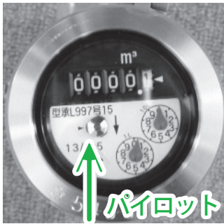
水道メーター
