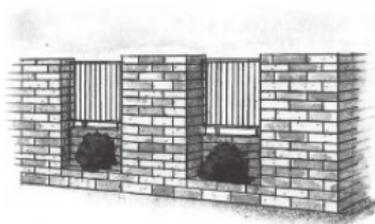
↑↓L型やT型の平面的な塀にすると、地震や風による転倒力に対する抵抗力が向上します
