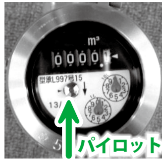
水道メーター
