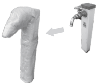
保温材(布切れ、古毛布など)を露出した水道管に巻き付け、その上からビニールテープを巻き固定する。
